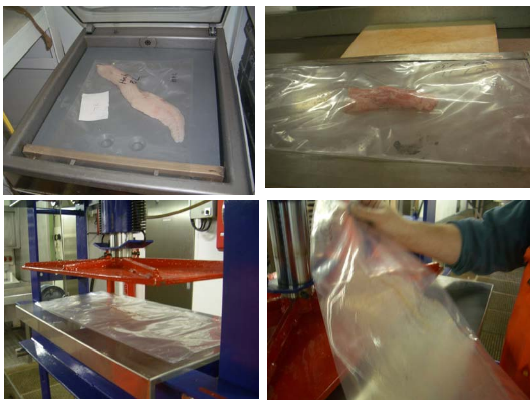
Figura 5: Preparación de prensado de filetes para la observación con luz ultravioleta (366 nm) de larvas de Anisákidos (método de Karl y Leinemann, 1993)
